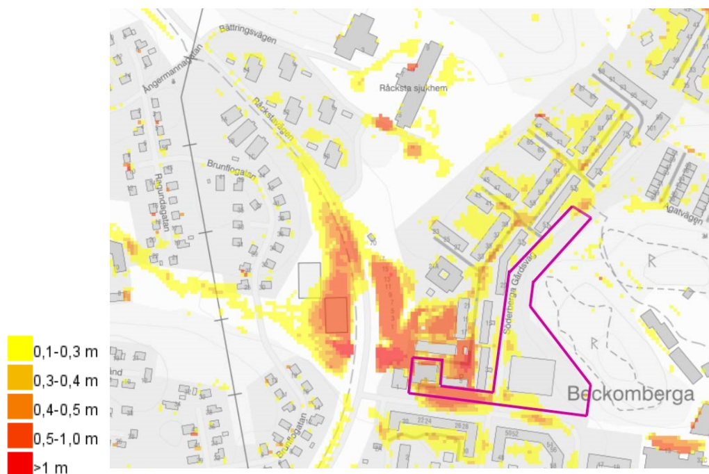
Utdrag ur Stockholms stads skyfallskartering. Legend till vänster representerar maxdjup vid skyfall.
