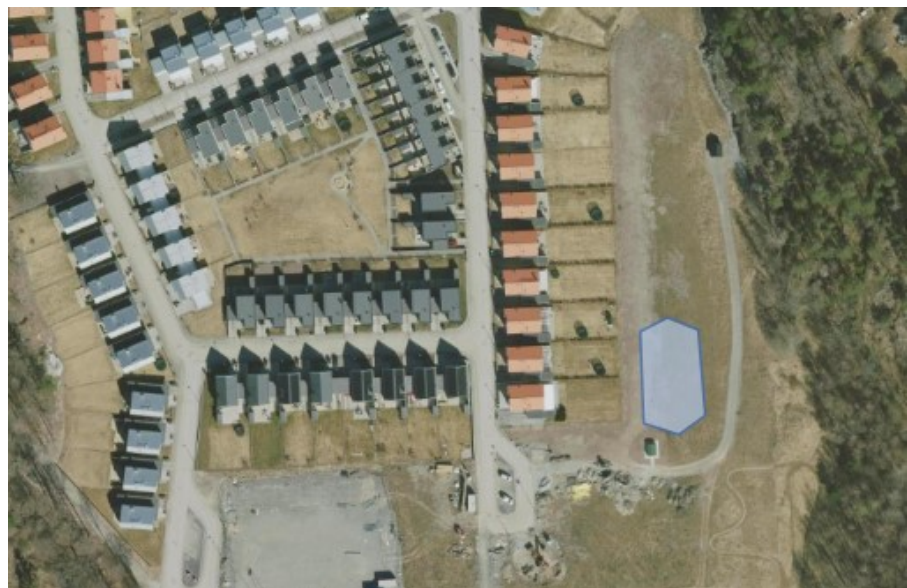
Figur 21. Illustration av ytbehov och möjlig placering av en dagvattendamm på 0,06 hektar (våtyta), vilket motsvarar cirka 1 % av avrinningsområdets reducerade yta.
