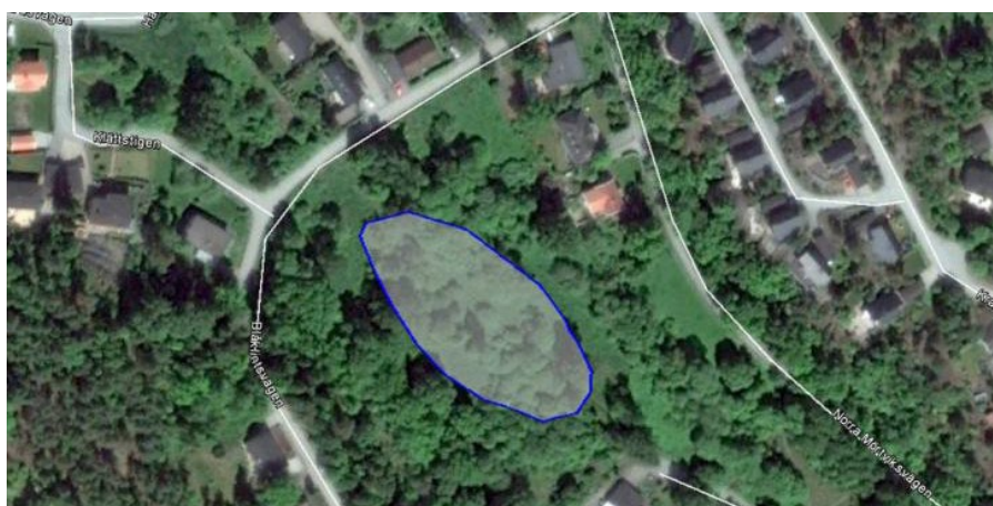
Figur 10. Illustration av ytbehov och ungefärlig placering av en dagvattendamm vid Blåklintsvägen på 0,4 hektar (våtyta), vilket motsvarar cirka 1 % av avrinningsområdets reducerade yta.
