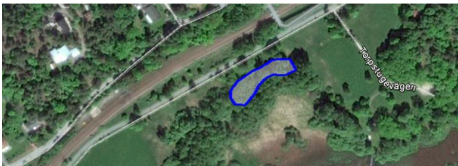
Figur 14. Illustration av ytbehov och ungefärlig placering av en våtmark eller översilning väster om Torpstugevägen på 0,14 hektar (våtyta), vilket motsvarar cirka 1 % av avrinningsområdets reducerade yta.
