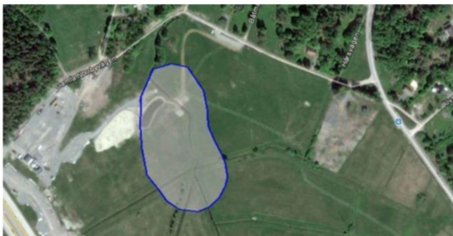
Figur 3. Illustration av ytbehov och ungefärlig placering av en dagvattendamm vid Norrby gårde. Ytan på 1,9 hektar (våtyta) motsvarar cirka 1 % av avrinningsområdets reducerade yta.
