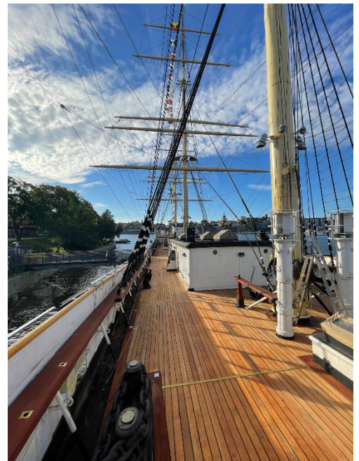
Trädäck efter renoveringen
