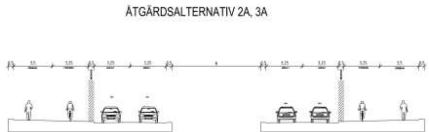
Figur 6. Normal brosektion till alternativen "ny bro" (åtgärdsalternativ 2A och 3A). Fri brobredd 13,25 m+13,25m och 8m mellan broarna.
