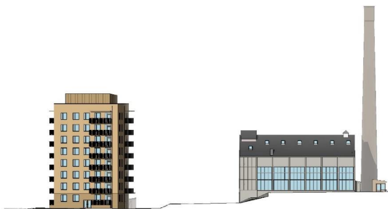
Gårdsfasader mot nordväst. På panncentralens norra fasad ska det ursprungliga glaspartiet i huvudsak återställas vid ombyggnad eller rivning (bild: Nyréns arkitekter).
