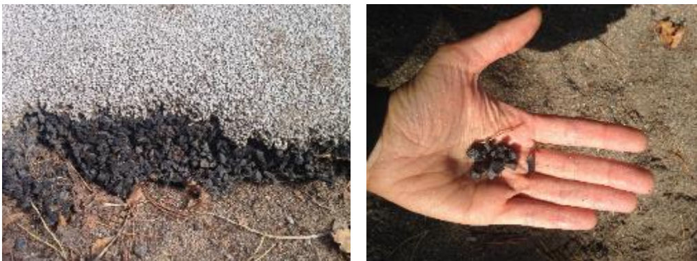
Till vänster en trasig yta och till höger lösa SBR-bitar på lekplatsen Lurparken. Bildkälla: Sofie Lindgren
