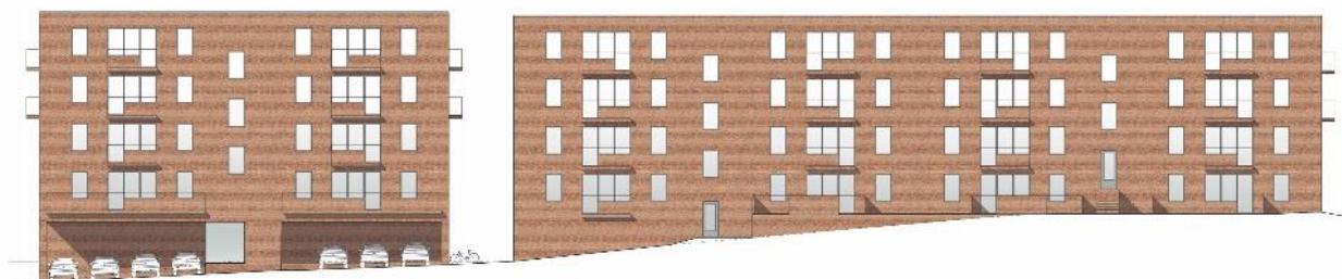
Fasader sydväst mot gården och befintlig bebyggelse. Mot gården varierar hushöjden mellan fyra våningar i kvarterets södra del där berget är som högst och fem våningar i den norra delen där marken ligger i samma nivå som gatan. Illustration Joliark.
