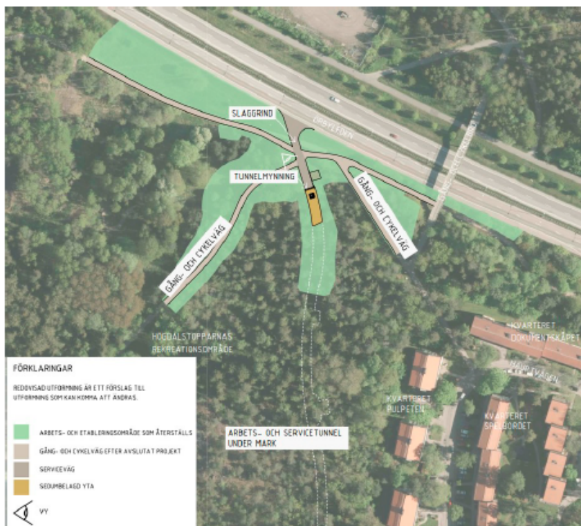
Illustrationsplan över arbets-/servicetunnels mynning mot Örbyleden. Ljusgrönt område avser det område som påverkas under byggskedet. Området kommer efter avslutat bygge att återställas.
