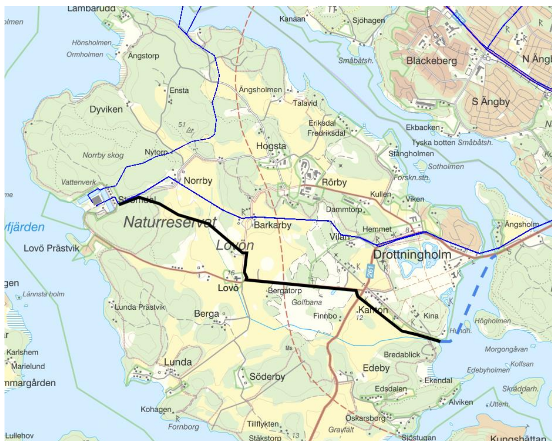
Figur 1. Befintliga ledningsstråk (blå heldragen linje) och förordat alternativ på ny huvudvattenledning (svart linje). Pågående projekt i Drottningholmssundet (blå streckad linje)
