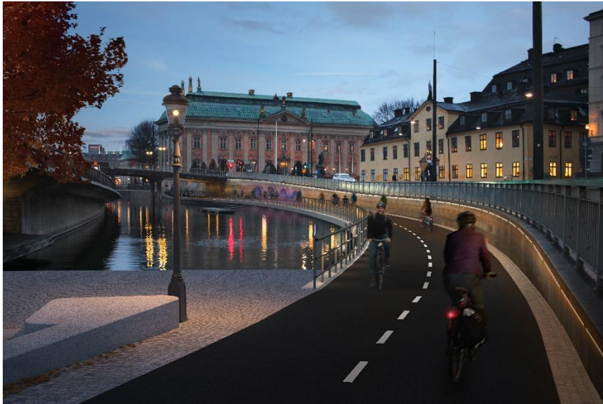
Bild 5. Fotomontage, vy norrut mot Riddarholmskanalen och Riddarhuset. Belysning i murkrön, räcke, gatlykta (av samma typ som längs med Riddarhuset) och effektbelysning under Riddarholmsbron och i valven.
