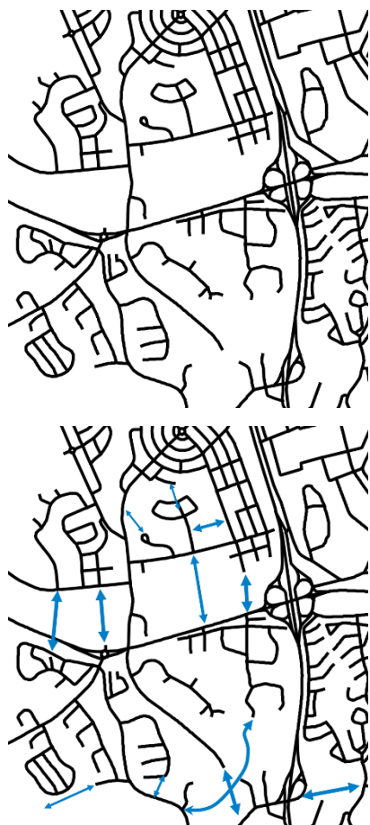
Figur 2. Principskiss över isolerade gatustrukturer och potentialen i att koppla samman med flera länkar.
