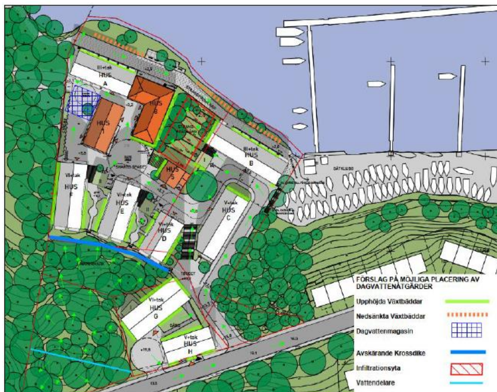
Förslag på placering av infiltrationsanläggningar och slutet dagvattenmagasin. Structor
