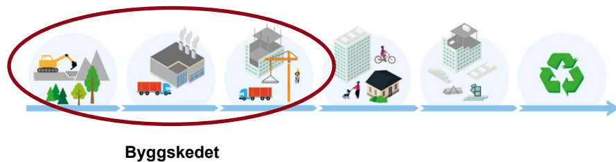
Figur 6. Regeringens lagförslag om klimatdeklarationen av byggnader är avgränsat till att utsläpp ska redovisas för byggskedet, det vill säga fram till färdig byggnad. Se även figur 9 för en tydligare beskrivning.
