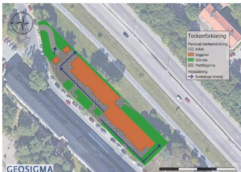
Nya flödesriktningar i förslaget till dagvattenlösning. (Geosigma)
