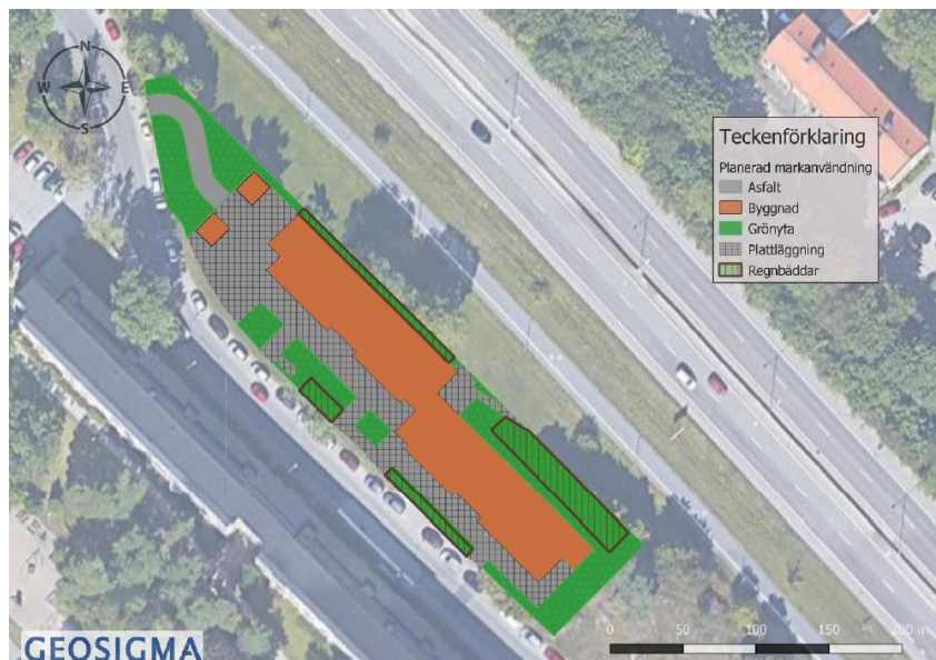
Exempel på förslag till dagvattenhantering. (Geosigma)
