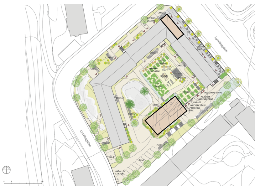
Situationsplan som redovisar den nya gårdsmiljön och placeringen av det nya gårdshuset i suterräng mellan gårdsnivån och garageentréns nivå, samt tillbyggnaden i kvarterets norra hörn mot Lysviksgatan. (Bild: Vardag arkitekter)
