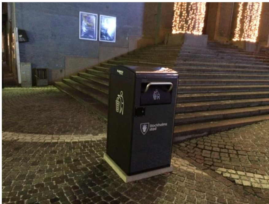
Komprimerande sopkärl som drivs av egengenererad solcellsel
