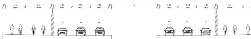
Figur 7. Bred brosektion till alternativen "ny bro" (åtgärdsalternativ 2B och 3B) Fri brobredd 18,25 m+18,25m och 8m mellan broarna.
