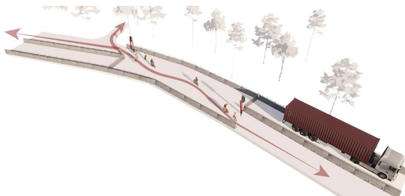
Bild 8, Skarpnäcksvägens sluss som visar att passagen öppnar för gång- och cykeltrafik när byggtrafiken passerat slussen.
