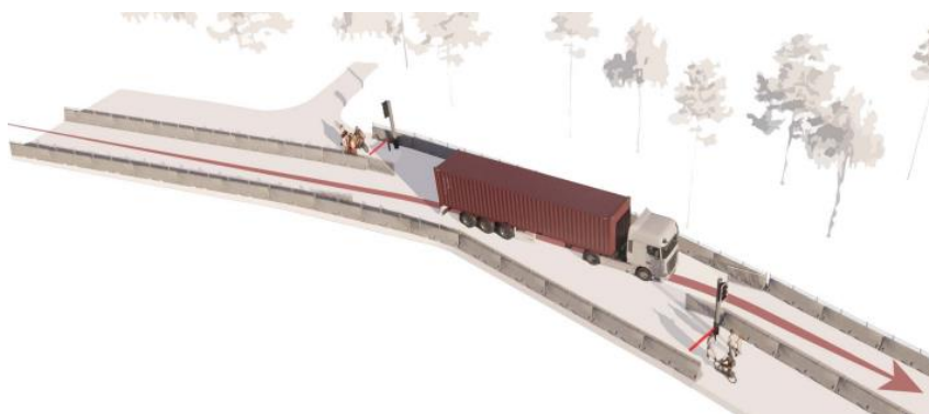
Bild 7, Skarpnäcksvägens sluss som visar öppen passage för byggtrafiken och stängd väg för gång- och cykeltrafik
