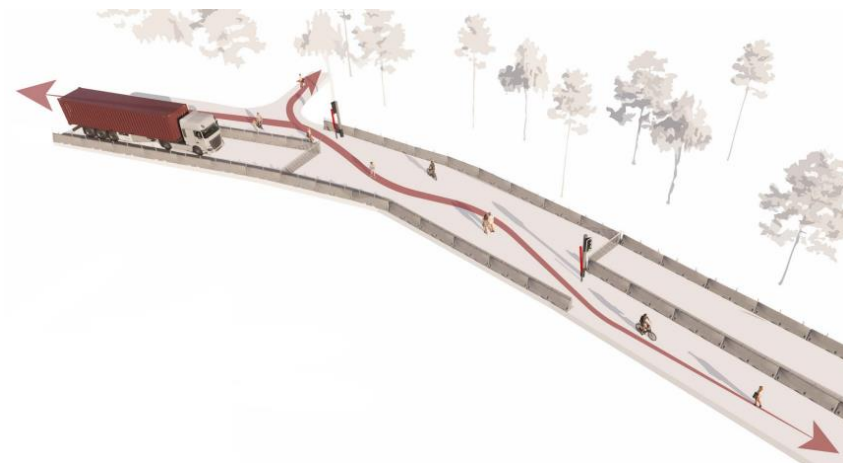
Bild 6, Skarpnäcksvägens sluss som visar öppen passage för gång- och cykeltrafik och stängd väg för byggtrafiken.
