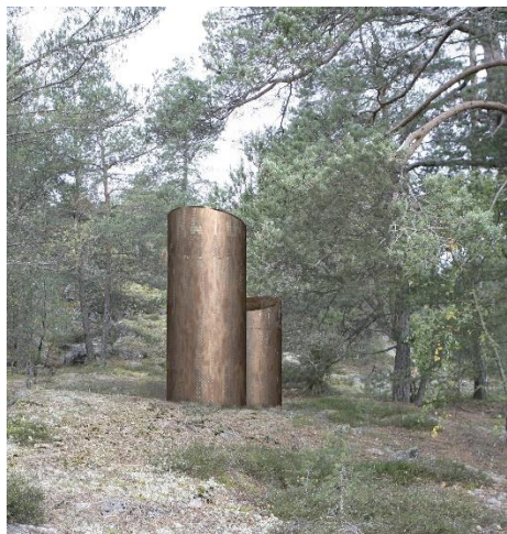
Figur 21 - Exempel på hur brandgasschakt och utrymning kan se ut vid alternativ med böjd bergtunnel.
