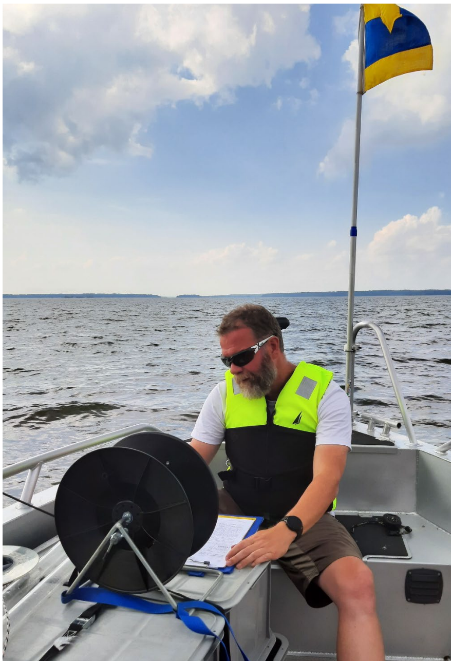
Temperatur- och syrgasprofil från ytan till botten mäts upp via digital mätutrustning med mycket lång sladd. Foto: Joel Segersten, SLU.
