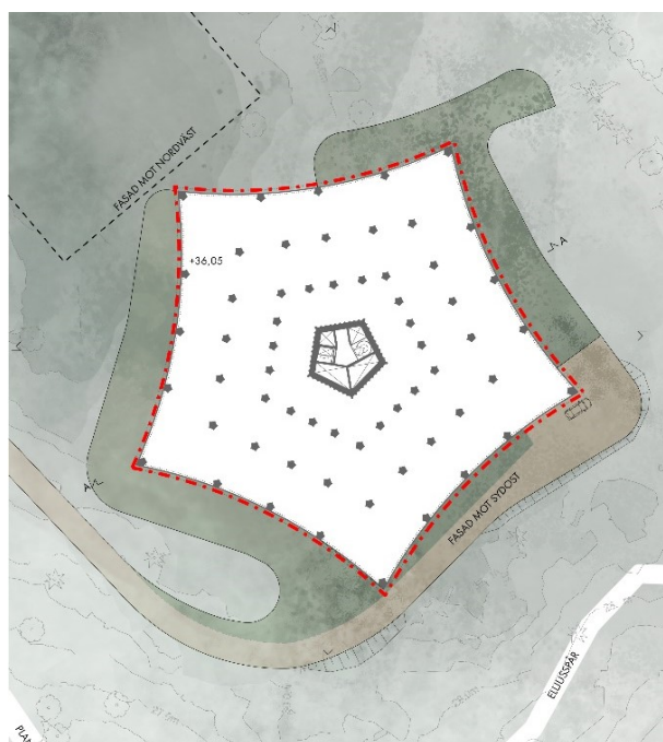
Plan 1 redovisar mittornet och pelarna, som utförs med ett femhörnigt tvärsnitt med konkava sidor.
