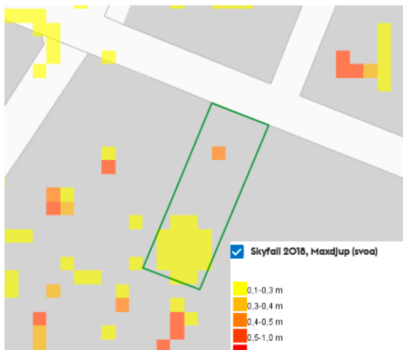
Utsnitt från Skyfallsmodellering för Stockholms stad som visar sannolikheten för översvämning med minst 0,1 m djup vid ett 100-årsregn.
