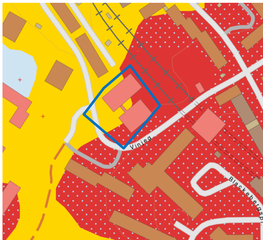
Figur 4. Jordartskarta utdragen från SGU (Källa: Sveriges Geologiska Undersökning, 2018). Planområdets ungefärliga gränser är markerad i blått. Gult område motsvarar glacial lera, rött är urberg och rött med blåa prickar motsvarar urberg med tunt eller osammanhängande ytlager av morän.
