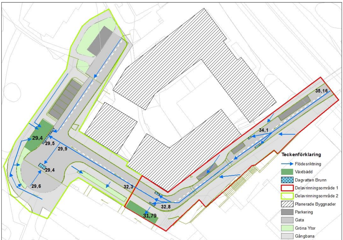
Figur 6. Översiktsskarta på förslag till dagvattenhantering med flödesriktning av dagvatten och höjder.
