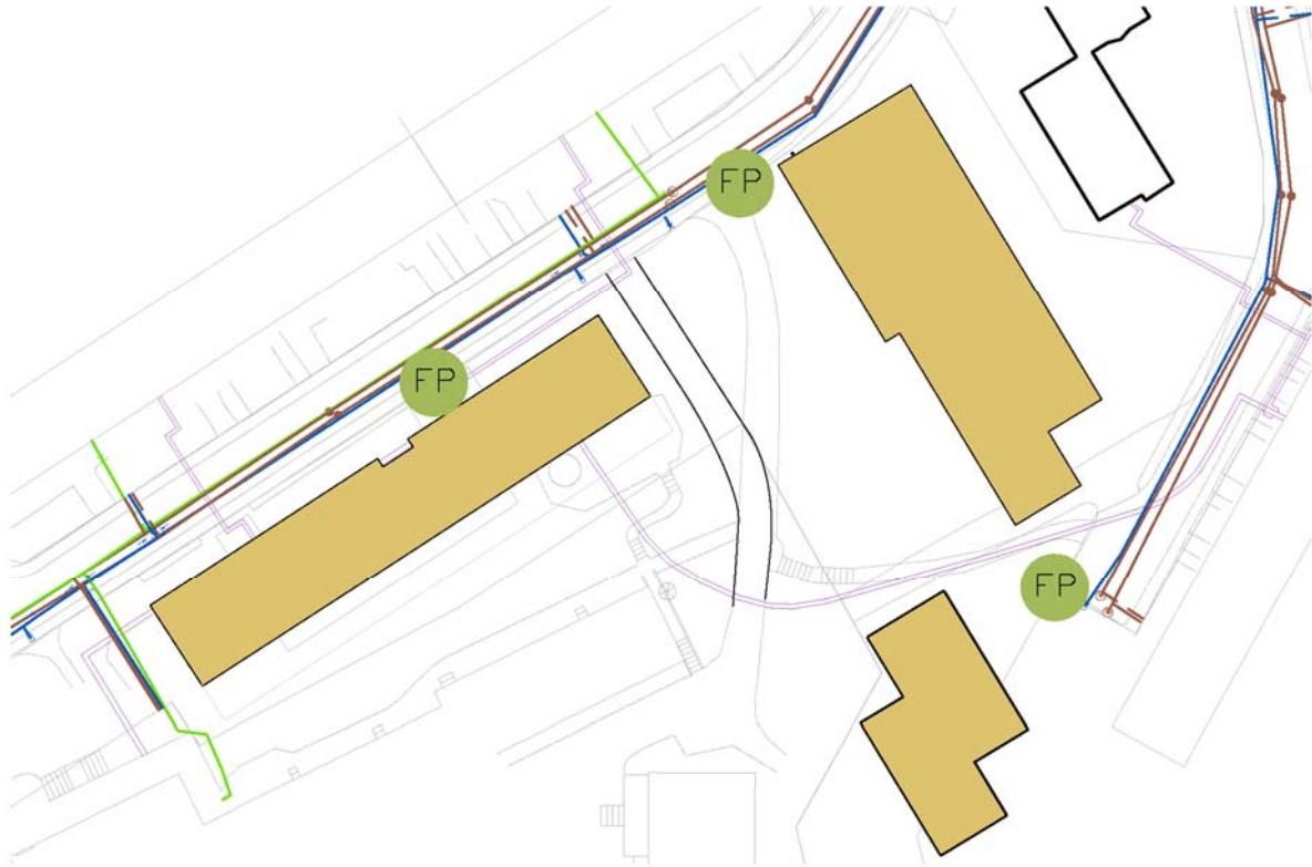
Figur 5. Tänkbara förbindelsepunkter för vatten, spillvatten och dagvatten
