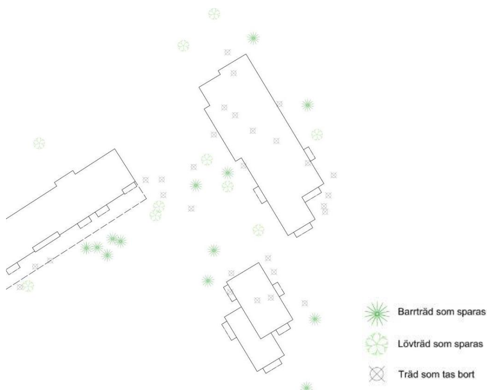
Utredning befintliga träd som kan sparas eller måste tas bort. Tyréns, 2018.
