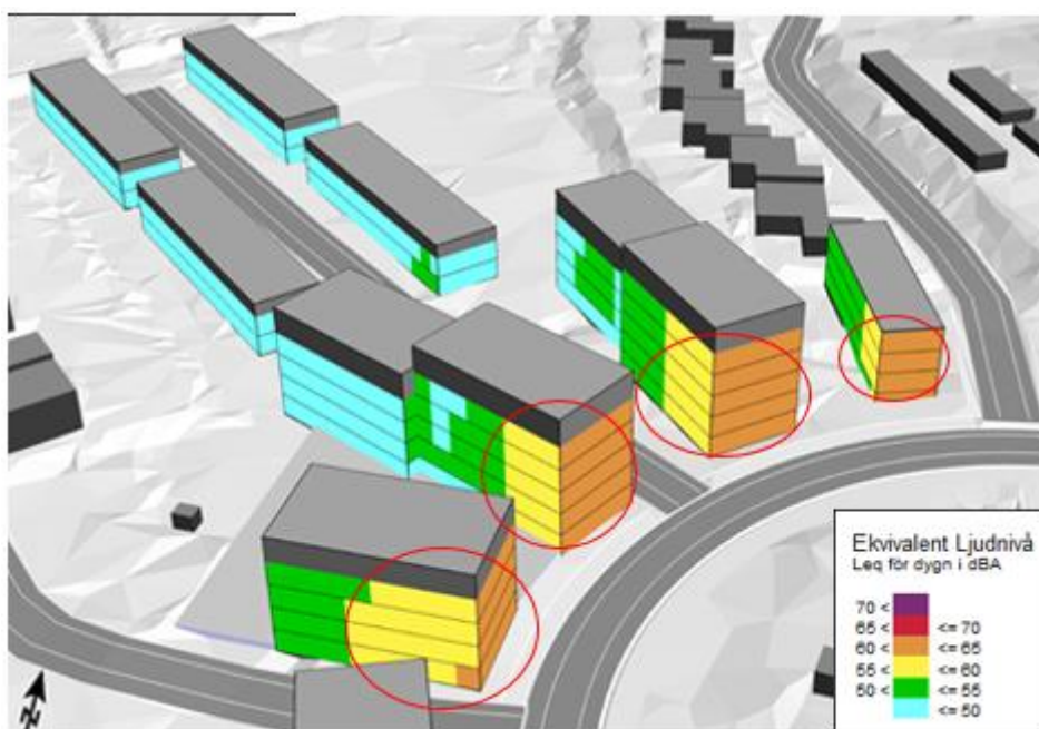
Figur 8: Fasader där ekvivalenta ljudnivåer överskrider 60 dBA och bullerskyddad sida saknas, BTH Bostads norra del
