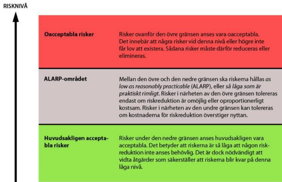
Figur 2: Konceptet med de två gränserna för acceptabla/oacceptabla risker, samt ALARP-området (Davidsson m fl, 1997).
