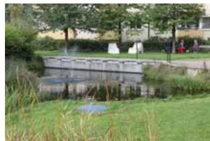
Permanent vattenyta med hjälp av grävatten från tvättstugor.
