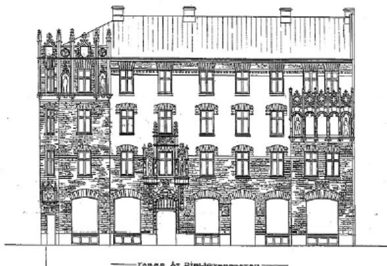
Ursprunglig fasad mot Biblioteksgatan som visar befintlig takfot och ursprunglig bottenvåning.
