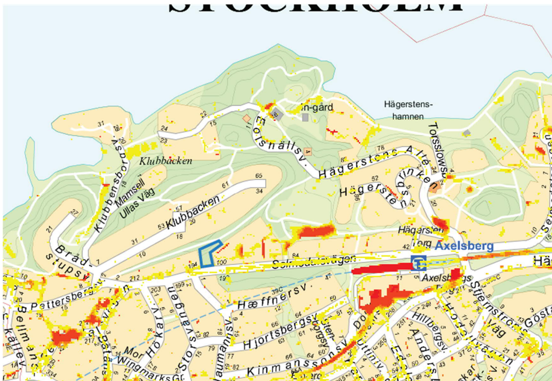
Fig. 6 Röda områden visar var vatten skulle kunna samlas vid extremt skyfall (100-årsregn). Bild från översvämningskartering av Stockholm Vatten och Avfall.
