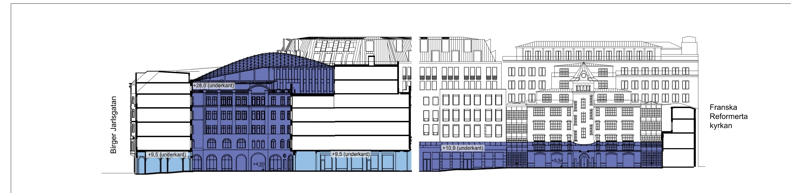
Sektion A-A, galleria med glastak, markerat med mörkblå färg, ska ha en minsta frihöjd i enlighet med denna sektion.
