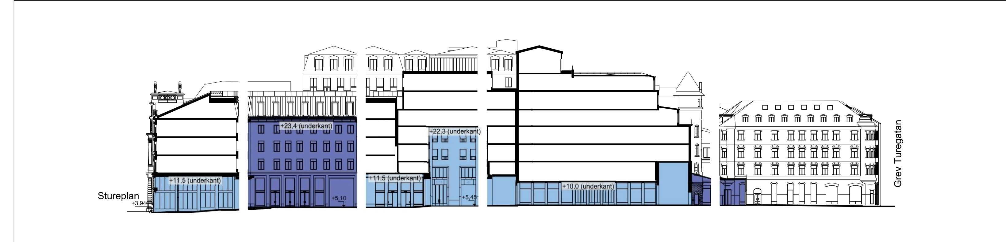
Sektion B-B, galleria med glastak, markerat med mörkblå färg, ska ha en minsta frihöjd i enlighet med denna sektion.
