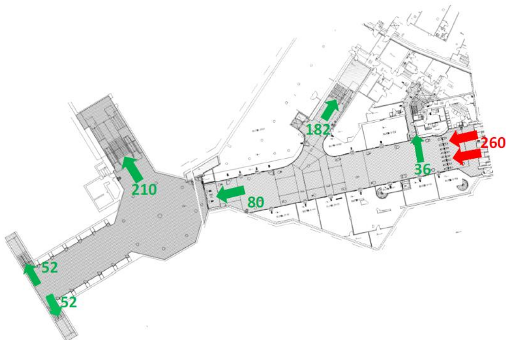
Figur 5. Utrymningskapacitet från befintlig station.
