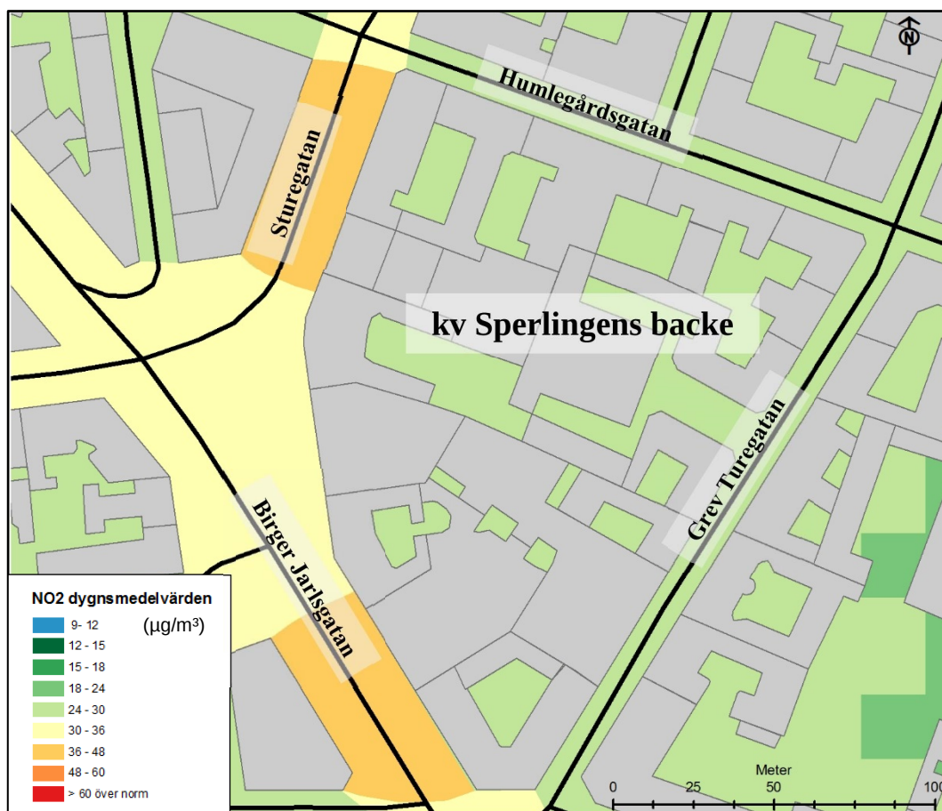
Figur 5. Beräknade dygnsmedelvärden av NO 2 i µg/m 3 det 7:e värsta dygnet år 2024. Normvärde som skall klaras är 60 µg/m 3 .
