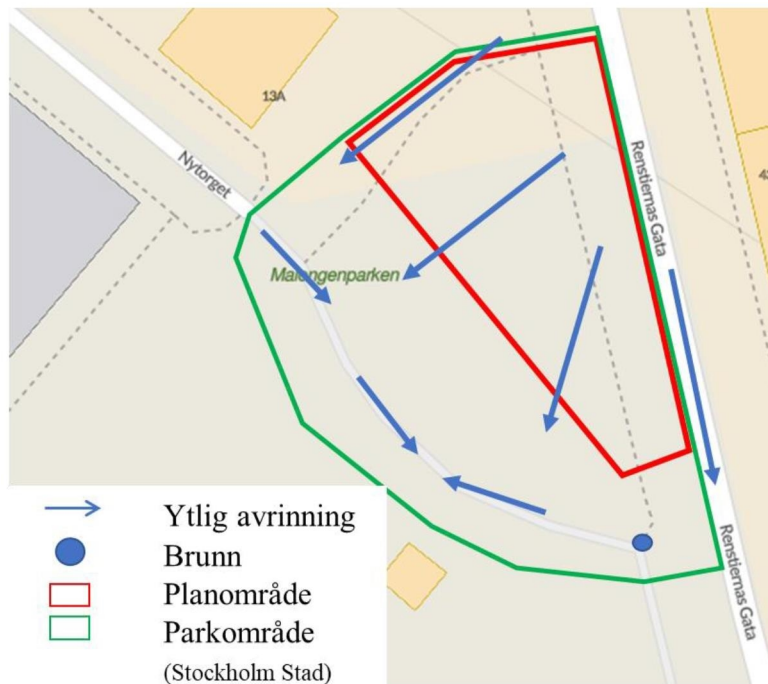
Figur 7. Troliga flödesvägar utifrån observerad lutning samt dagvattenbrunnar i området, markerat med pilar (avrinning) respektive cirklar (brunnar). Planområdet innehållandes kvartersmark är inritat (ungefärligt) i rött. Underliggande bild: hitta.se.
