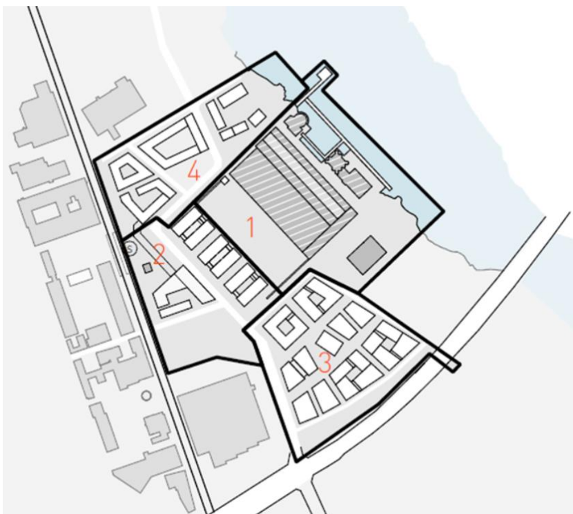
Figur 4. Byggnader inom område 1 föreslås bevaras eller byggas om. Områden 2-4 är förslag på nya byggnader.
