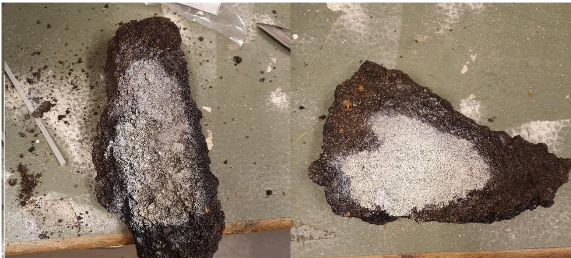
Figur 4. Bilder som visar de två lagren asfalt som testades med PAH-indikerande spray. Asfalt från det undre lagret ses till vänster i bild och asfalt från det övre lagret till höger i bild. Tyréns AB, 2019-10-03.
