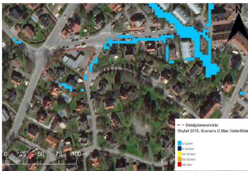
Utdrag ur Stockholms stads skyfallskartering som visar simulerat maxflöde.
