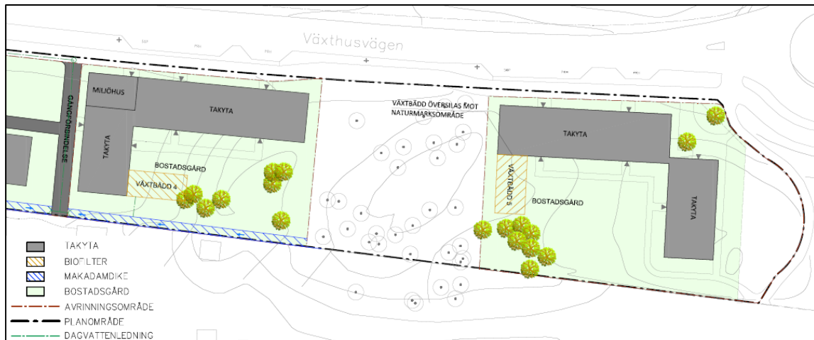
Figur 12 Förslag på dagvattenåtgärder i norra planområdet. Blått skrafferat område visar föreslaget makadamdike med rinnpilar (se hela planområdet i Bilaga 1).
