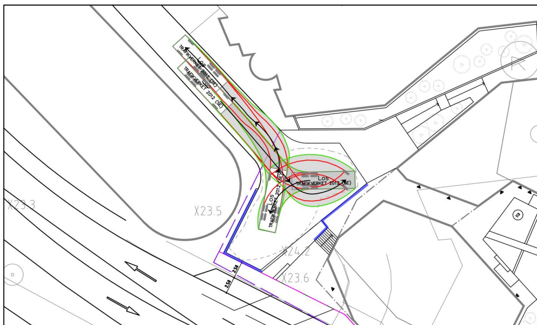
Figur 4-6 Körspåren visar hur en sopbil backar en fordonslängd för att vända. Blå linjer markerar räckan som styr gående bort från området där backning med lastbil förekommer.
