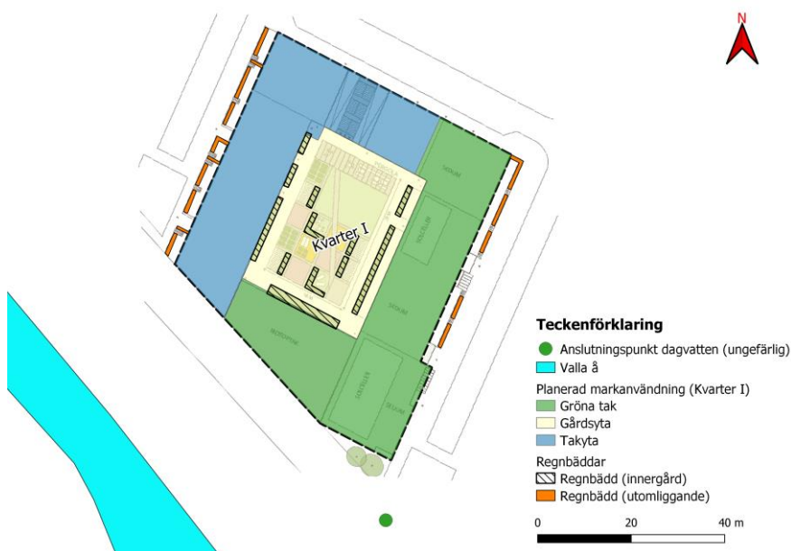
Figur 10-1. Planerat dagvattenhanteringssystem för utredningsområdet Kvarter I (regnbäddar och gröna tak).
