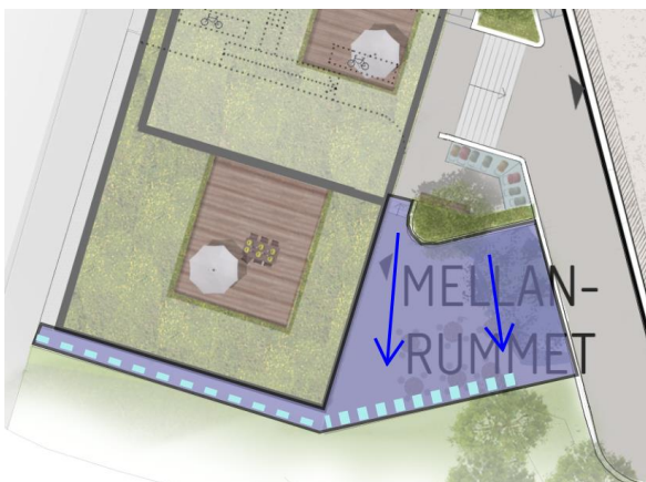
Figur 25. Avvatning av uteservering föreslås ske mot makadamstråk (streckad ljusblå linje) i söder.
