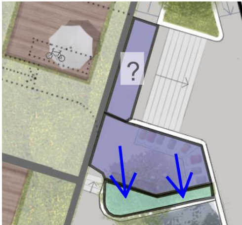
Figur 24. Barnvagnsparkering föreslås avvattnas mot växtbädd (grönmarkerad). Marklutning för yta till höger om bostadshusets portik är oklar i dagsläget. Lämplig lösning för avvattning av denna yta bör undersökas i senare skede.
