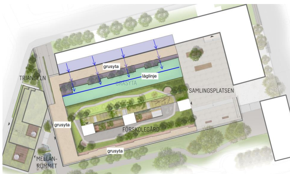
Figur 15. Planerad gräsyta på skolgård fördröjer och renar dagvatten från del av skoltak och trädäck på gräsytans norra del. Planerad låglinje i gräsmattan är utmärkt med en blå linje.
