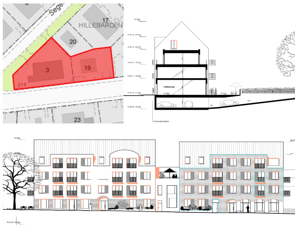
Figur 1. Översikt och planerad bebyggelse enligt A-ritningar upprättade av Urban Couture Arkitekter, daterade 2020-05-14. Lägsta golvnivå planeras ligga på +20,36, motsvarande ca 2,7 – 3,4 m djup under angränsade gators befintliga gatunivå (ca +23,1 – +23,8).
