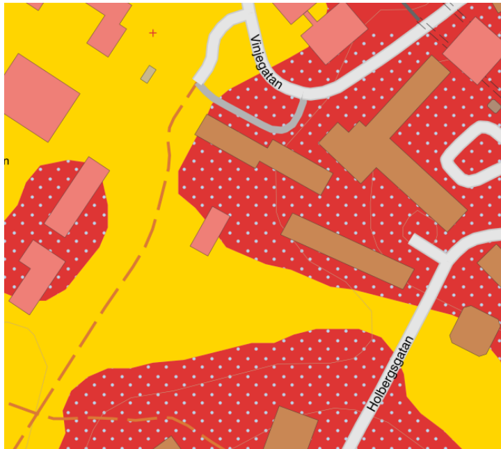
Figur 2. SGU jordartskarta. Den Gula färgen representeras av lera, och den röda färgen med vita prick av fyllning som underlagras av ytnära berg eller berg i dagen.
