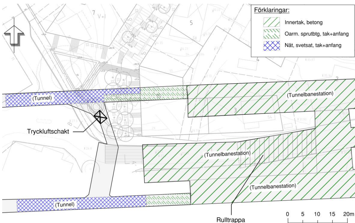
Figur 4. Ungefärlig omfattning av bergförstärkning inom inspekterat område. Inom hela området är selektiva bultar del av typförstärkning.
