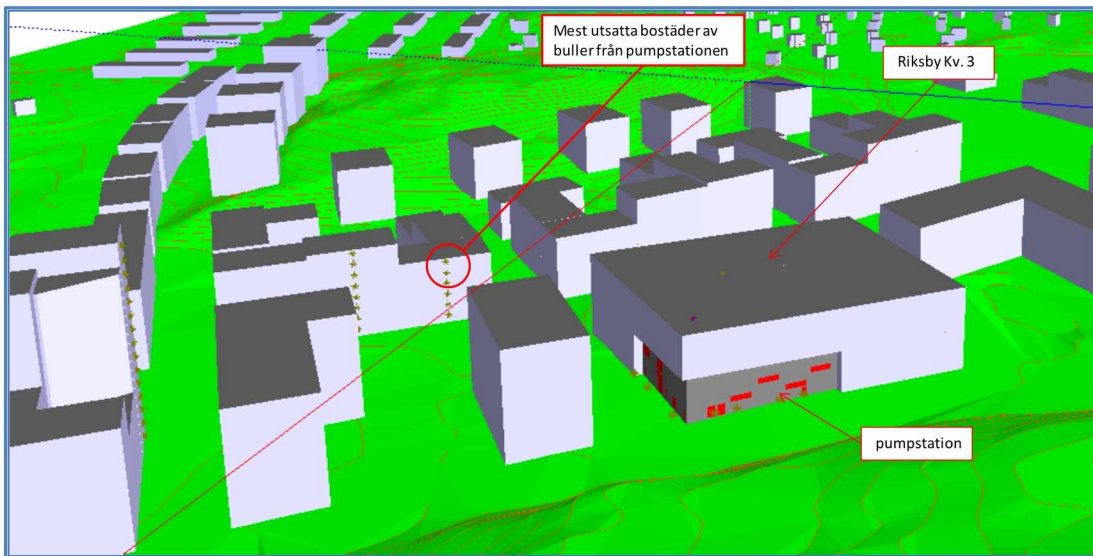
Figur 1: Utsnitt av beräkningsmodellen med pumpstation och mest utsatta bostäder.
