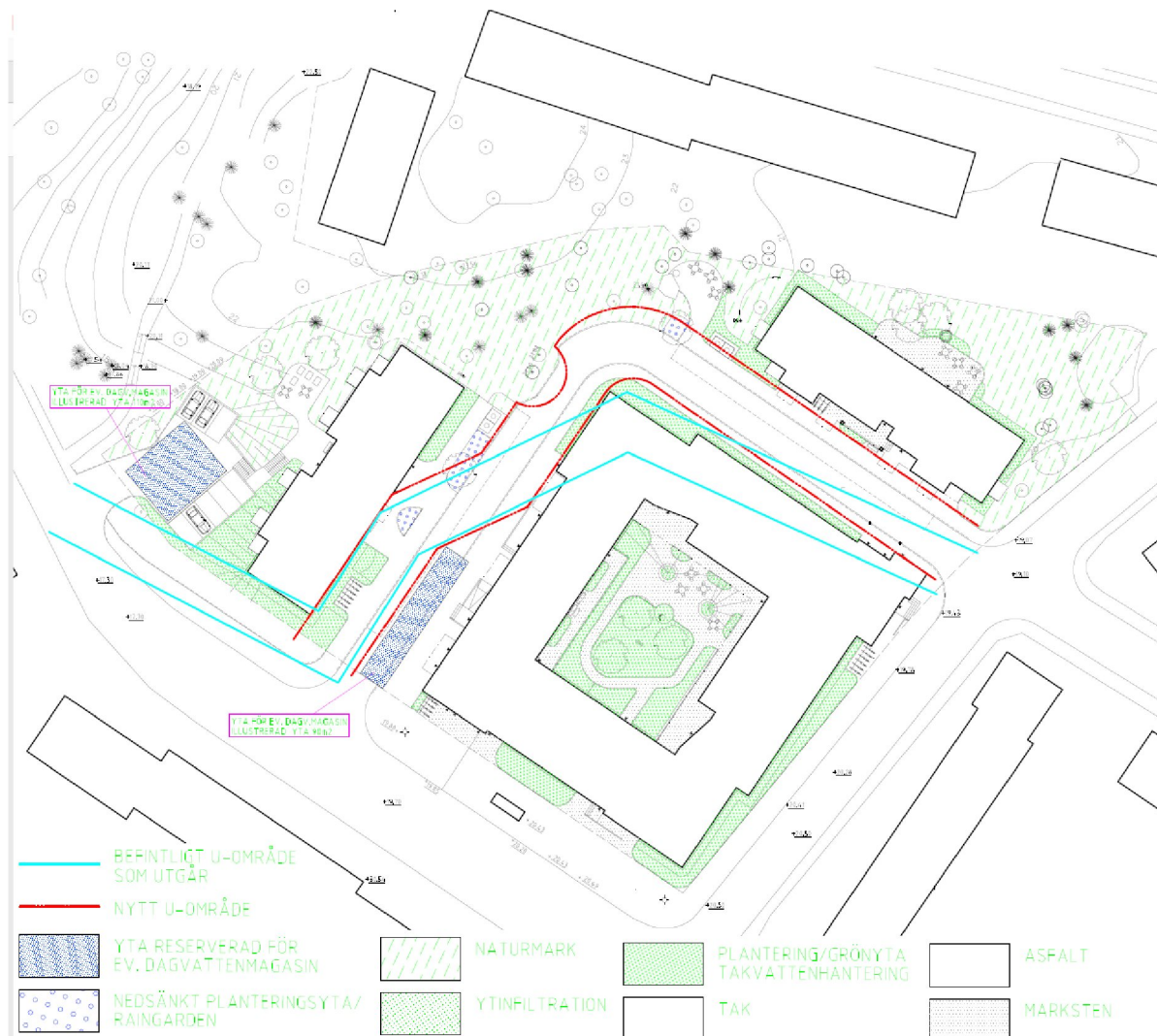
Fig. 8 Förslagskiss på dagvattenhantering, Novamark/Wi Landskap.
