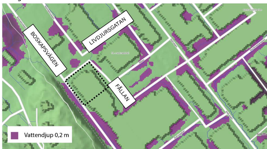
Figur 8. Lågpunktskartering i Scalgo (2020-12-14). Lågpunkter visas i lila (minsta vattendjup om 0,2m), utredningsområdet i svart och rinnvägar i blått.
