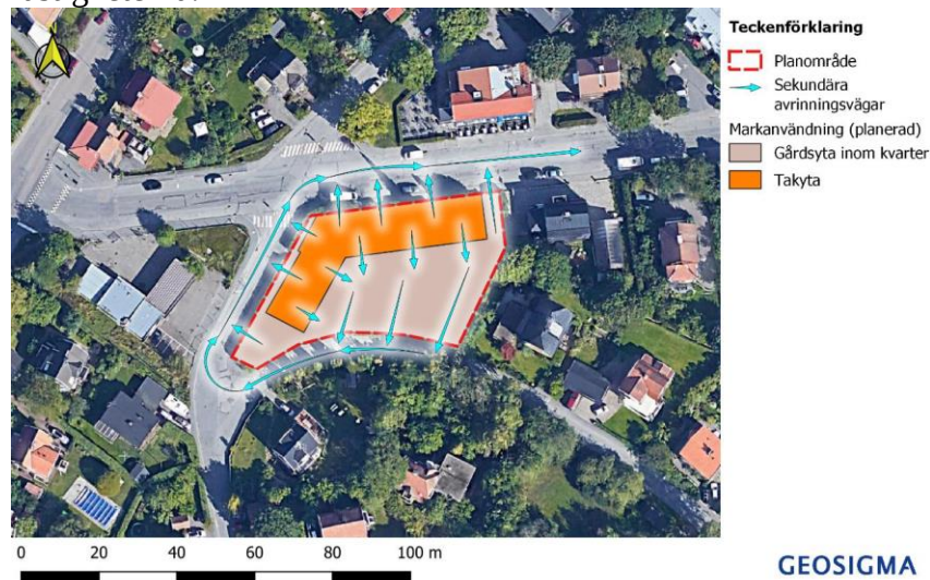
Bilden visar åtgärdsförslag för sekundära avrinningsvägar (Geosigma, 2020)
