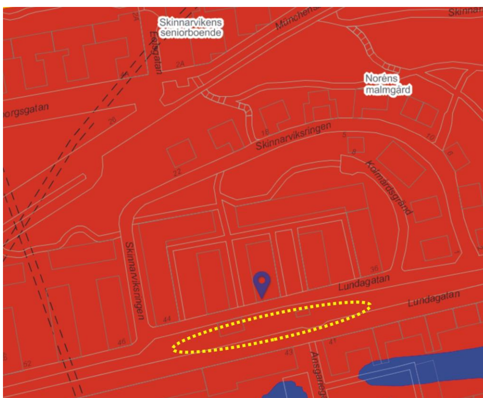
Figur 3. Jordarter inom planområdet. Rött motsvarar berg i dagen och blått morän. Den gula ovalen visar var planområdet ligger. Källa grundkartan: Byggnadsgeologiska kartan. PM Geoteknik – Projekteringsunderlag. Hillstatik AB. 2015-05-21.
