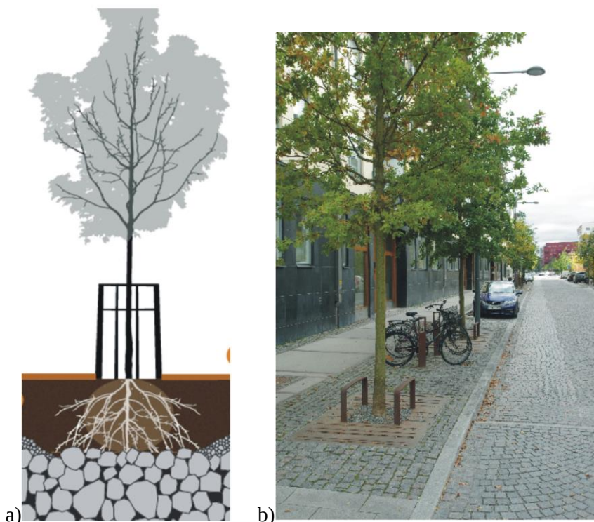
Figur 9 a) Exempel på vanlig skelettjord där det översta lagret utgörs av matjord medan det undre lagret består av makadam. Källa: Stockholm Vatten 10 . b) Träd planterad med skelettjord.
