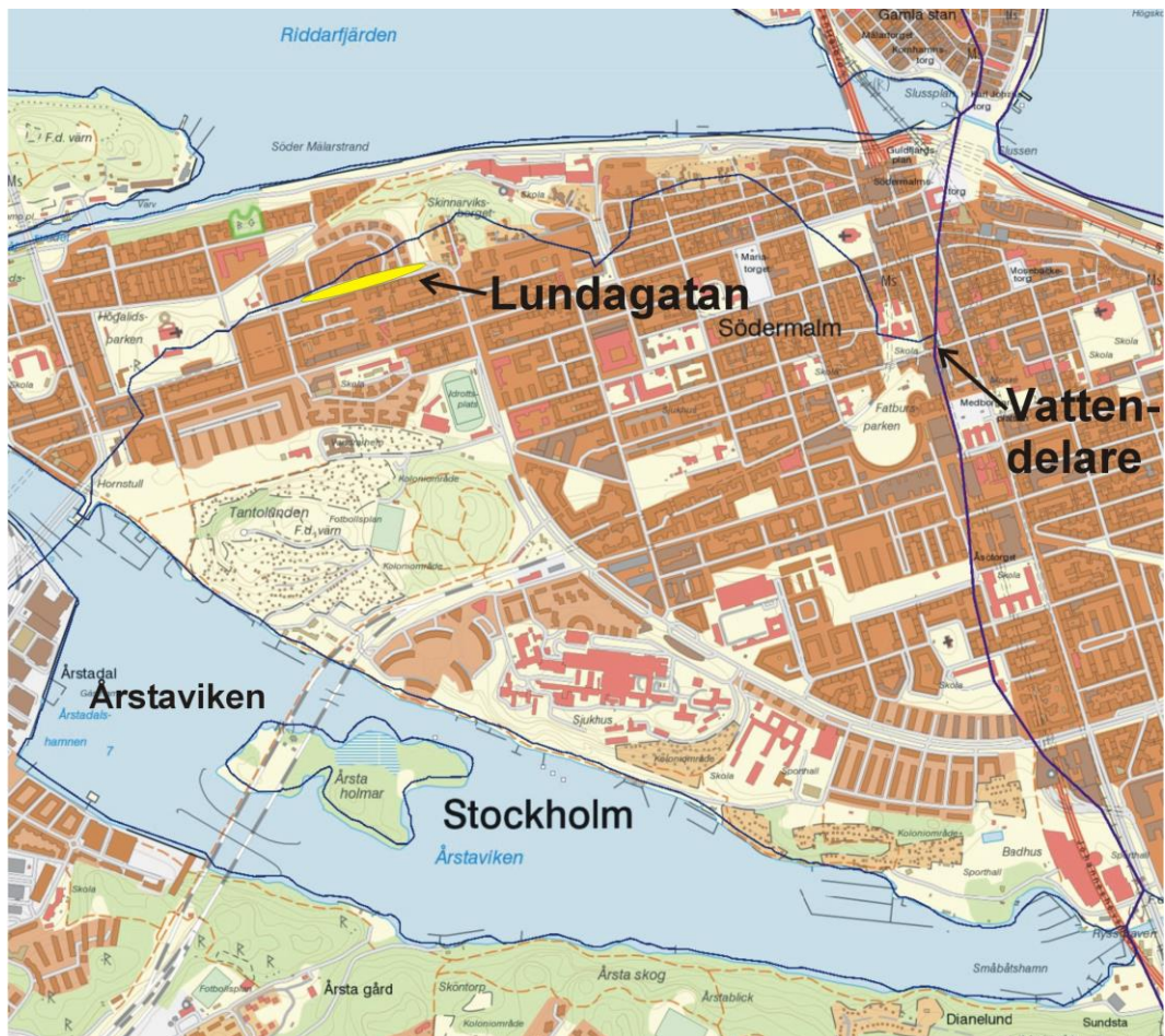
Figur 4. Ytavrinningsområde. OBS det mesta dagvatten från området avrinner i kombinerat ledningsnät till Strömmen via Henriksdals reningsverk. Endast dagvatten från den västra delen av Nedre Lundagatan avleds mot Årstaviken.
